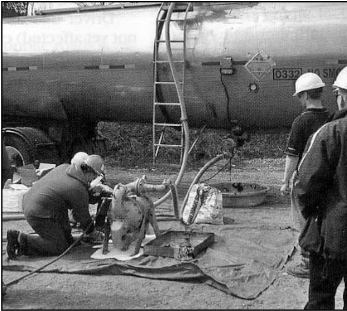
Exercice de transfert de produit en temps réel impliquant une émulsion en vrac. Le but de cet exercice était de démontrer les capacités de Transport Canada dans le cadre de l'évaluation du PIU.
